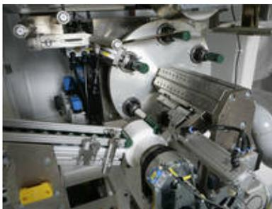
Abrollpräge-System für das hochpräzise Heissprägen von runden und unrunder Verschlüsse in Aluminium oder Kunststoff (Long Caps, Dosen, Flaschen etc.).
