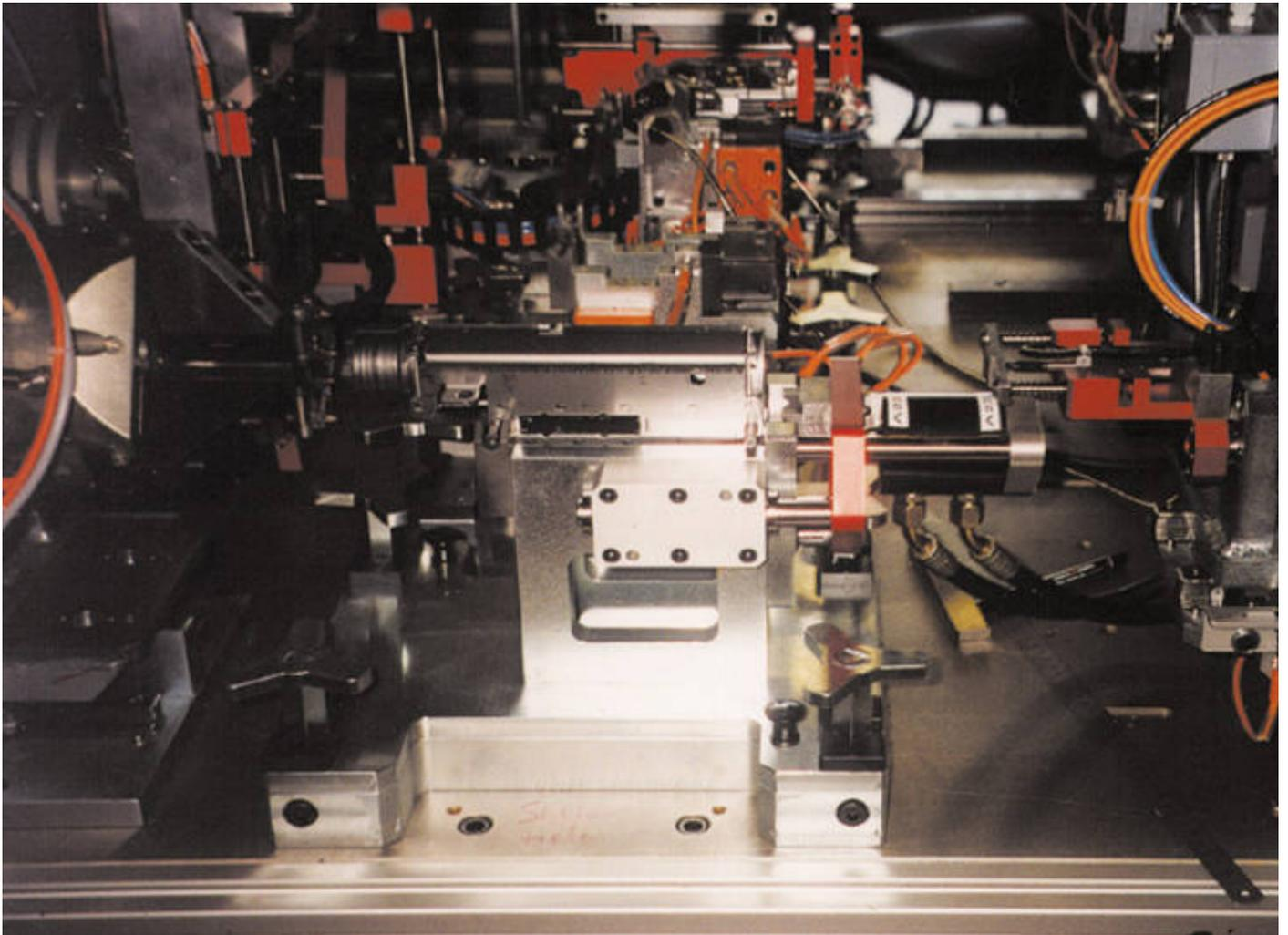
Entwicklung verschiedener Montagestationen für die Herstellung von Lenksäulen für die Automobilindustrie.
